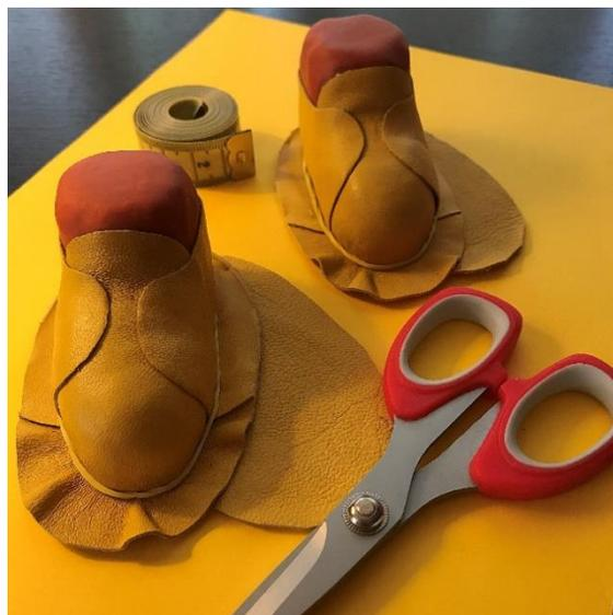
Приклеим стельку к верхней части ботинка, для этого смажем клеем припуск верхней части. Также смажем клеем стельку в месте припуска (стельку приклеиваем лицевой стороной кожи внутрь ботинка, чтобы ботинок красиво смотрелся изнутри). Дадим клею немного выдержки и плотно прижмем.
