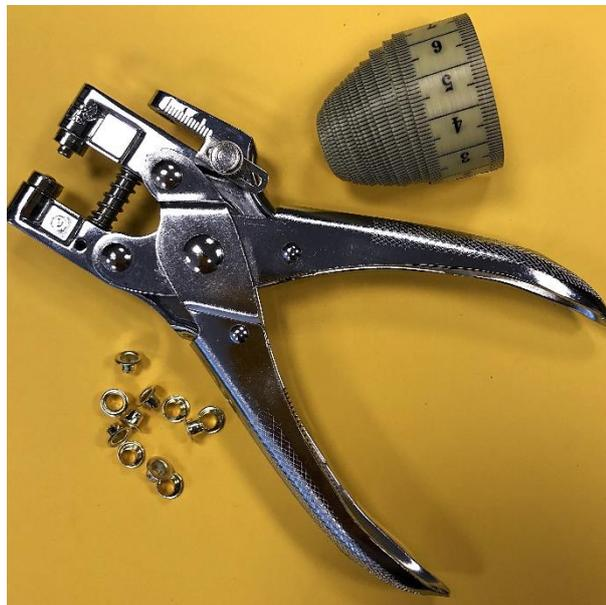
Сначала с помощью этого инструмента в коже проделывается дырочка, а затем на нее устанавливается люверс. Приобрести такую машинку можно в интернете или в больших канцелярских магазинах. Набор люверсов продается вместе с машинкой.
