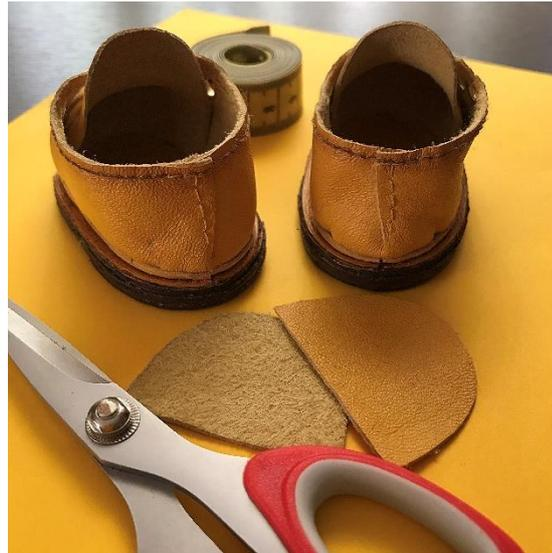
Делаем надрез по центру ботинка сзади и прошиваем его, закладывая вытачки от внешней стороны ботинка внутрь, как показано на фото сверху. При этом, несколько стежков делаем по верхнему шву вправо и влево от вытачки для закрепления строчки. В вытачку забираем столько кожи, сколько необходимо для плотного прилегания ботинка к лапе.
